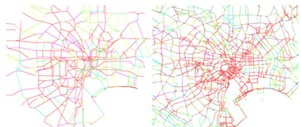
図 10 東日本大震災当日 20 時台のリンク速度主題図 (左: 管制データ 右: シミュレーション結果)
