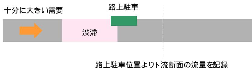
図1 路上駐車が断面容量に及ぼす影響の再現性検証
