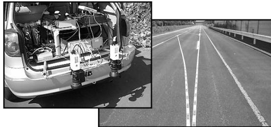
図-6 路面撮影カメラと路面の巻尺
