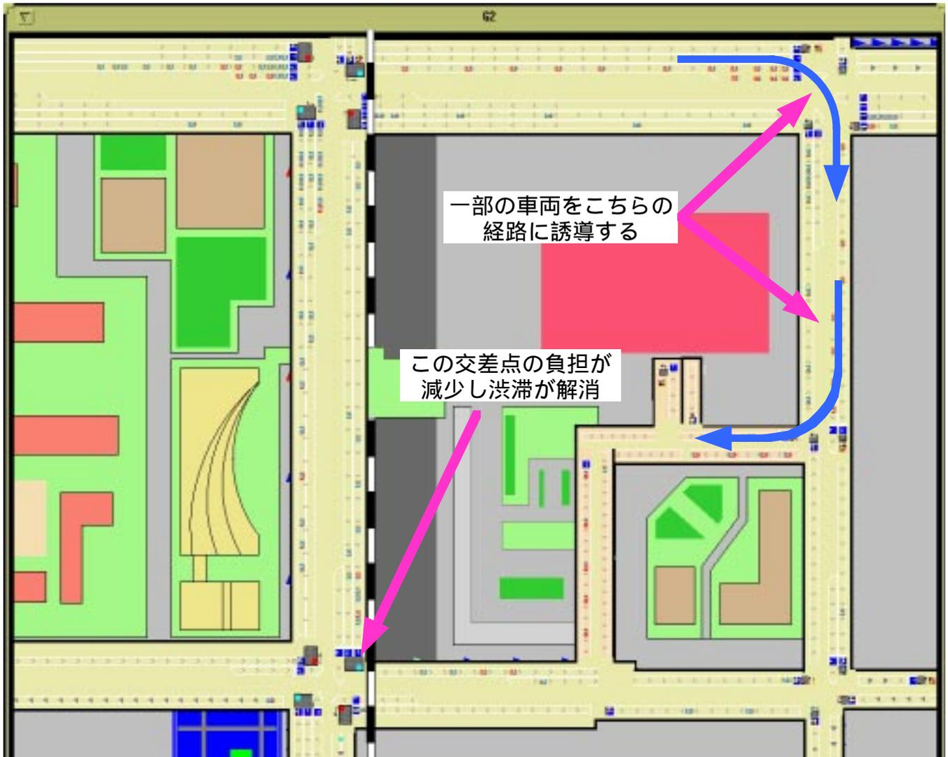
図5-28：誘導方式を変更した例
